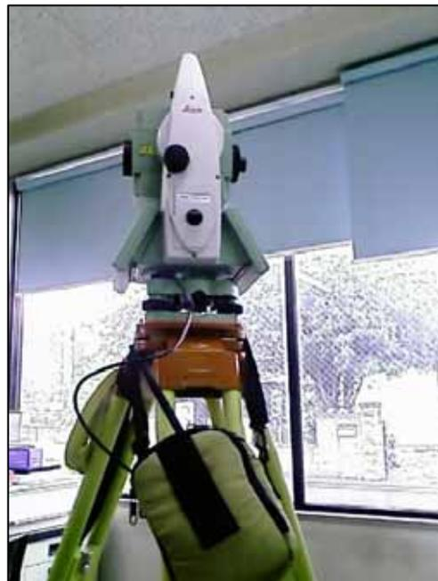
ライカ TPS1200 本体下の接続口へケーブルを挿入します。
