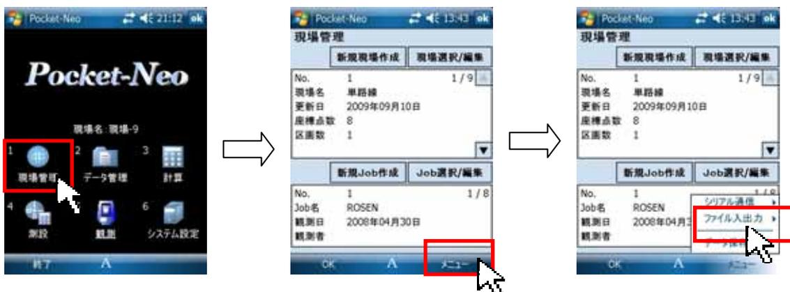
「APA観測ファイル書き込み」を選択し、出力するジョブにチェックして「OK」をタップします。予め「場所」をカードに変更しておきます。「SD Card」またはCFカードが挿入されていれば「CF Card」を選択します。次に「名前」を入力して「保存」をタップします。
