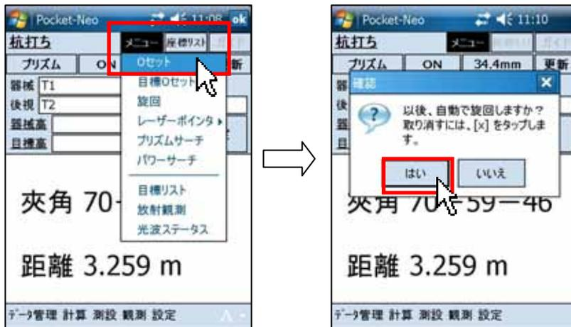
前述の操作で望遠鏡が目標点方法へ旋回されたら、目標点箇所を「測定」で観測します。
